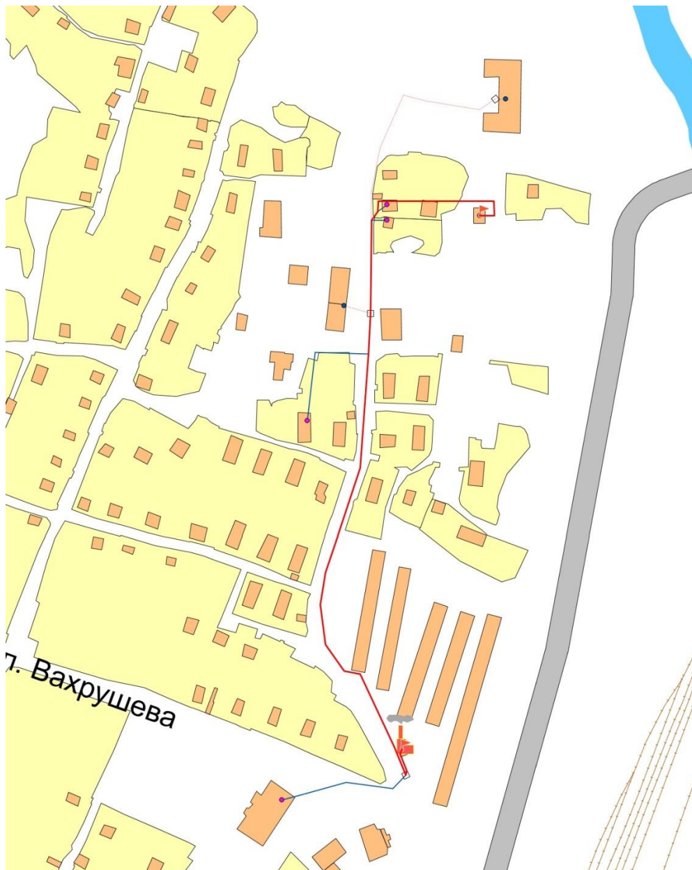
Рис. 5. Путь движения теплоносителя от котельной ОАИТ Верхняя Терраса МУП "МТСК" до конечного потребителя
