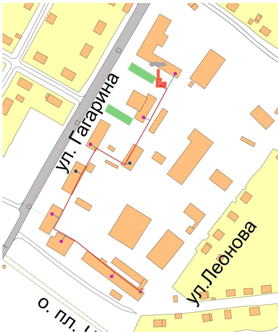
Рис. 8. Путь движения теплоносителя от котельной ОАИТ Чебал-Су МУП "МТСК" до конечного потребителя
