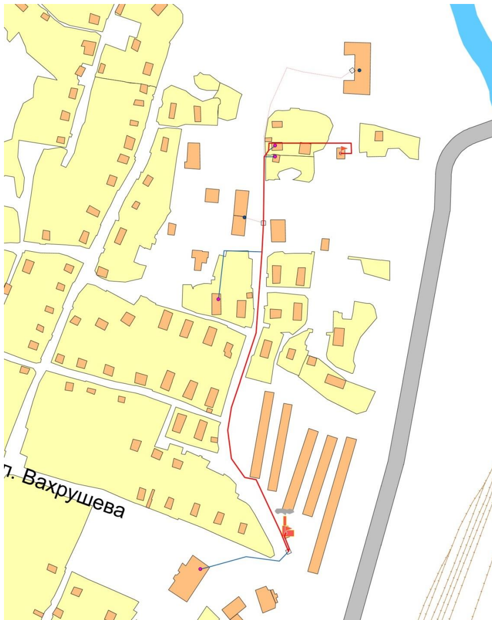
Рис. 9.5. Путь движения теплоносителя от котельной ОАИТ Верхняя Терраса МУП "МТСК" до конечного потребителя
