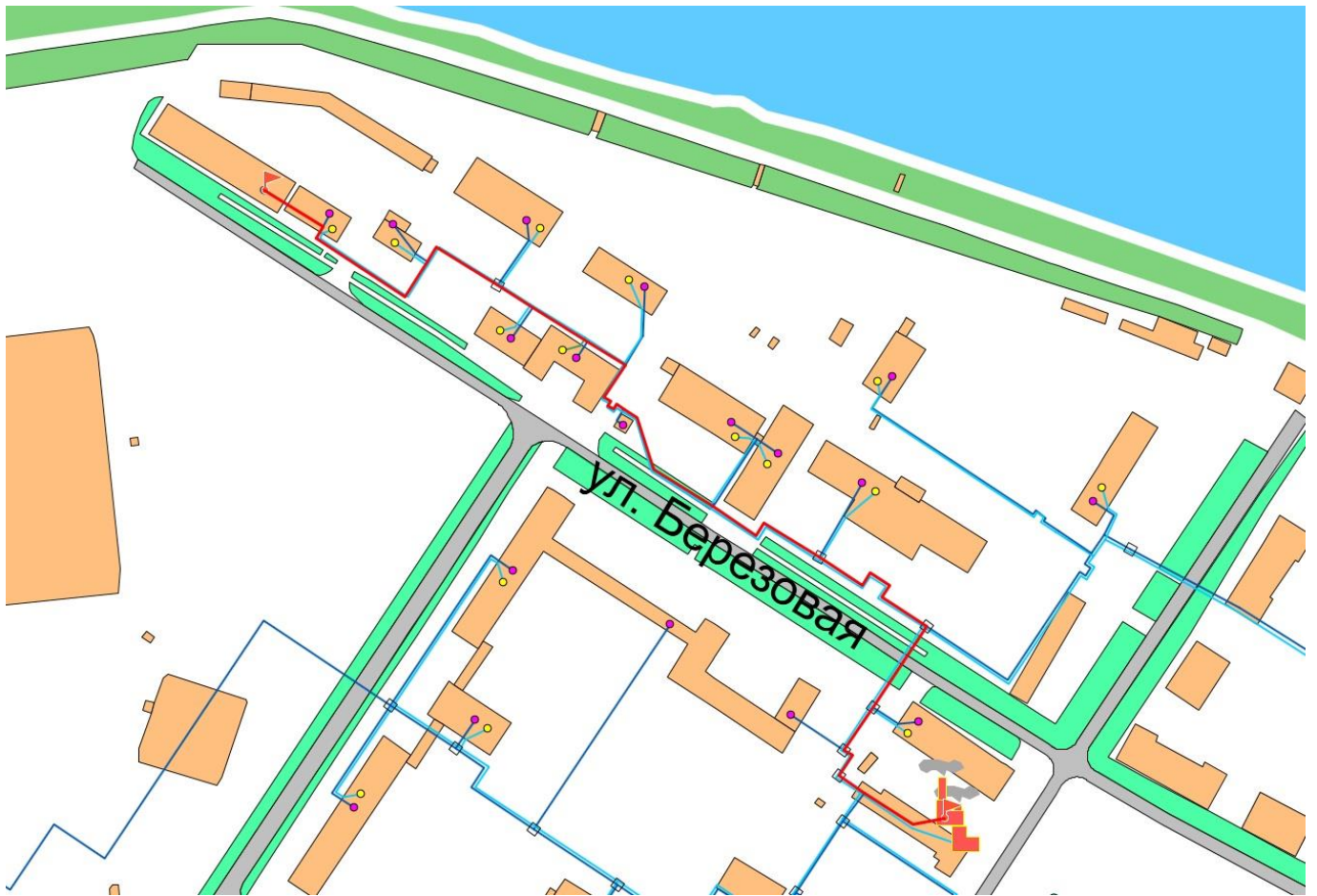
Рис. 3. Путь движения теплоносителя от котельной №11 МУП "МТСК" до конечного потребителя
