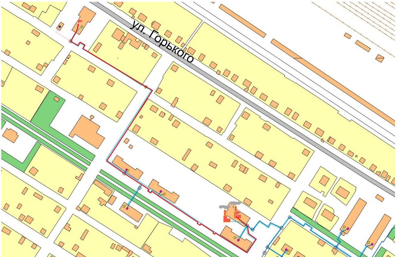
Рис. 9.1. Путь движения теплоносителя от котельной №2 МУП "МТСК" до конечного потребителя
