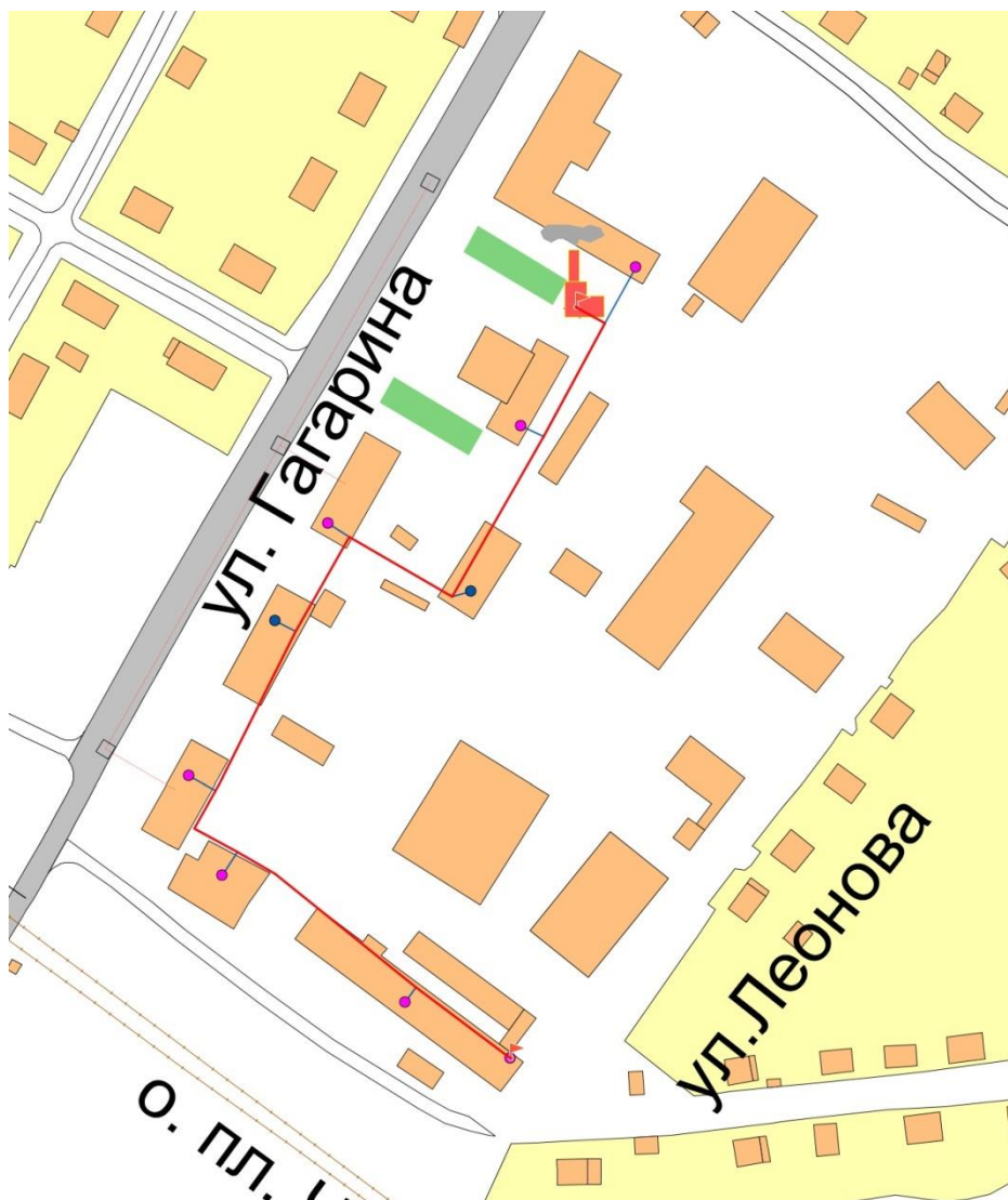
Рис. 8. Путь движения теплоносителя от котельной ОАИТ Чебал-Су МУП "МТСК" до конечного потребителя
