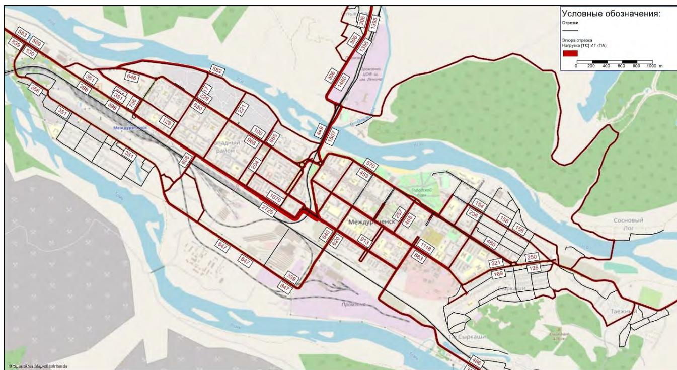
Рисунок 14 – Прогнозная картограмма расчетного транспортного спроса (нагрузки) на участки УДС города Междуреченск в утренний час пик, 2034 год.
