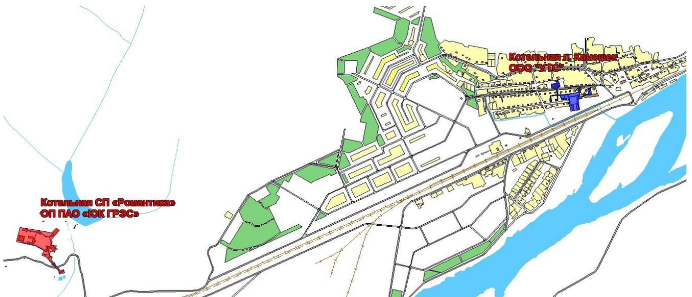
**Рис. 2.3. Существующие зоны действия тепловых источников в районе Камешек по состоянию на 2019 г.**
