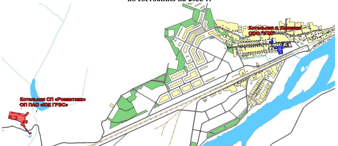
Рис. 2.15. Перспективные зоны действия тепловых источников в районе Камешек по состоянию на 2033 г.
