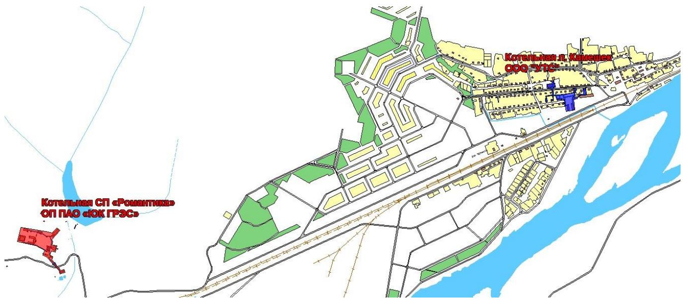
**Рис. 2.3. Существующие зоны действия тепловых источников в районе Камешек по состоянию на 2018 г.**
