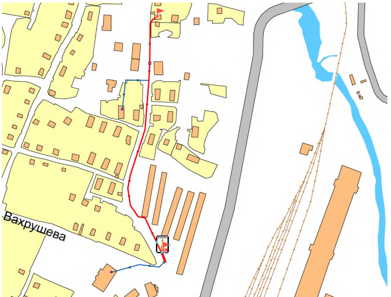
Рис. 9. Путь движения теплоносителя от котельной ОАИТ Верхняя Терраса МУП "МТСК" до конечного потребителя
