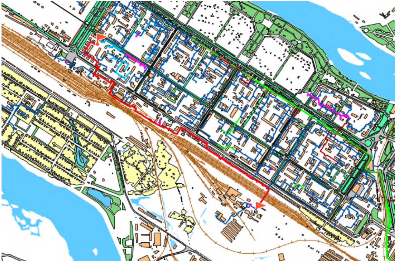
Рис. 18. Путь движения теплоносителя от Междуреченской котельной ООО ХК "СДС-Энерго" до конечного потребителя
