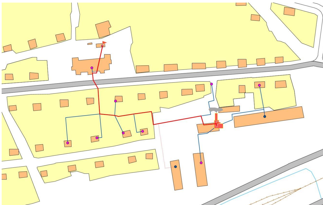
Рис. 12. Путь движения теплоносителя от котельной п. Камешек ООО "УТС" до конечного потребителя
