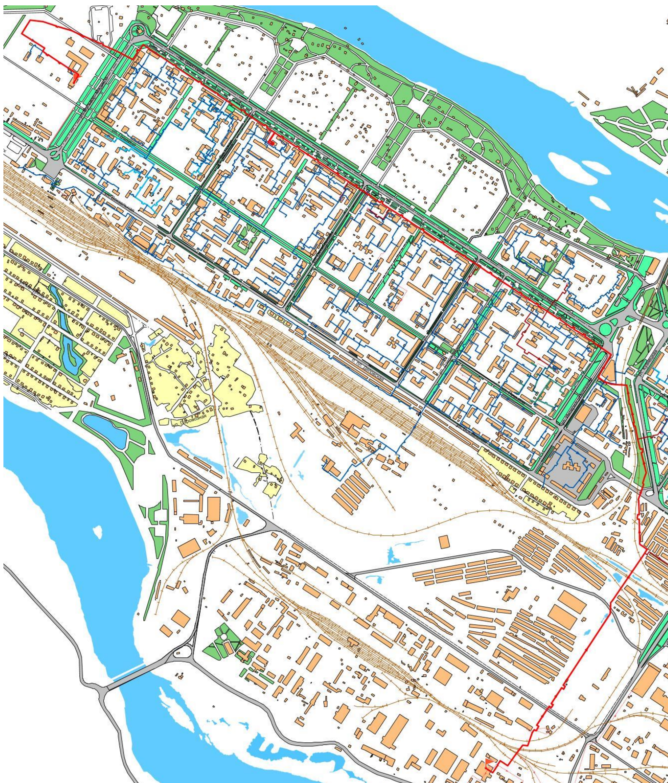
Рис. 9. Путь движения теплоносителя от Районной котельной МУП "МТСК" до конечного потребителя
