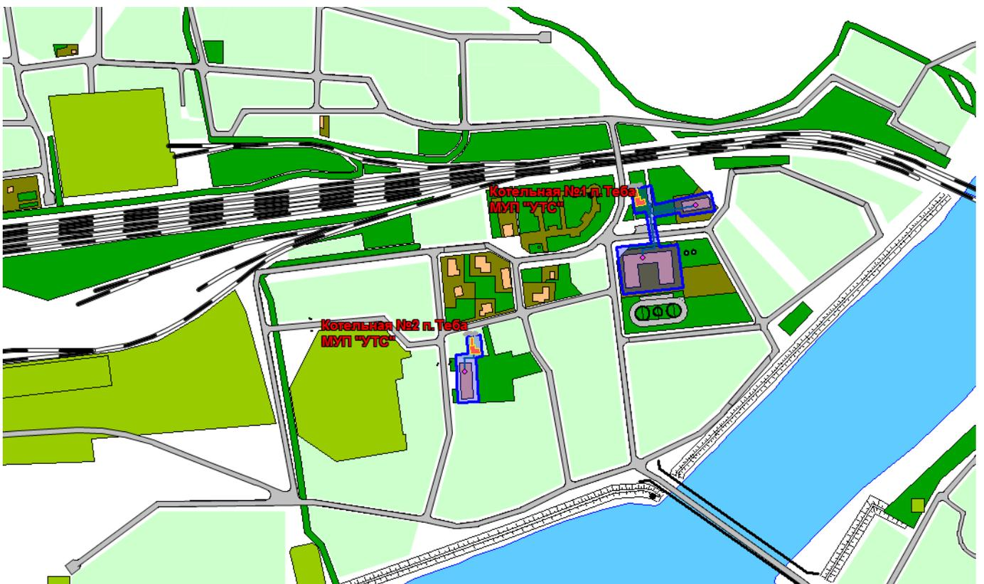
Рис. 2.8. Существующие зоны действия тепловых источников в п. Теба по состоянию на 2015 г.
